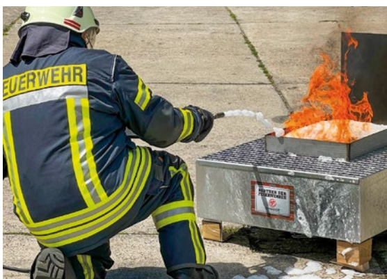
Übungsgerät: Mit den Schaumtrainern kann der richtige Einsatz von Schaummittel trainiert werden.
