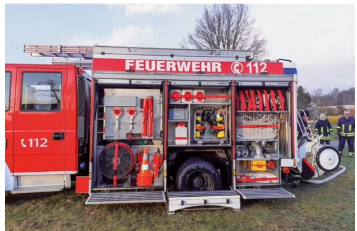
Linke Seite: Hier lagern Gerätschaften zur Verkehrssicherung und für den Brandeinsatz. Am Heck sind zwei Haspeln mit B-Schläuchen aufgeprotzt.
