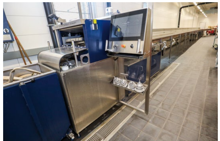
Schlauchpflegeanlage: Feuerwehrdruckschläuche sollen einmal jährlich und nach Benutzung druckgeprüft werden. Im Jahr 2020 wurden ca. 3.700 Druckschläuche gewaschen und geprüft.
