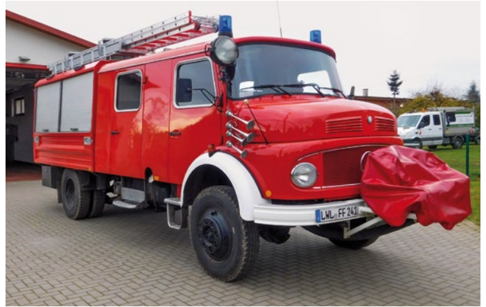
Baujahr 1981: Dieses LF 8/6 ergänzte die FF in Eigenleistung um einen 600-l-Löschwassertank, eine dreiteilige Schiebleiter und einen Lichtmast.
