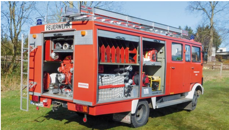
Funktionstüchtig: Das LF verfügt über zwei Pumpen. Einen Wassertank hat es jedoch nicht.
