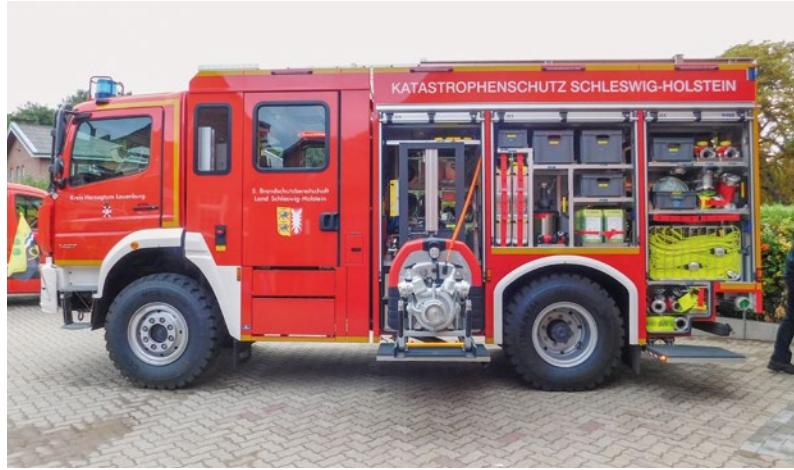
Linke Fahrzeugseite: Hier finden sich vor allem Geräte für den Löscheinsatz sowie die PFPN auf einem Auszug.
