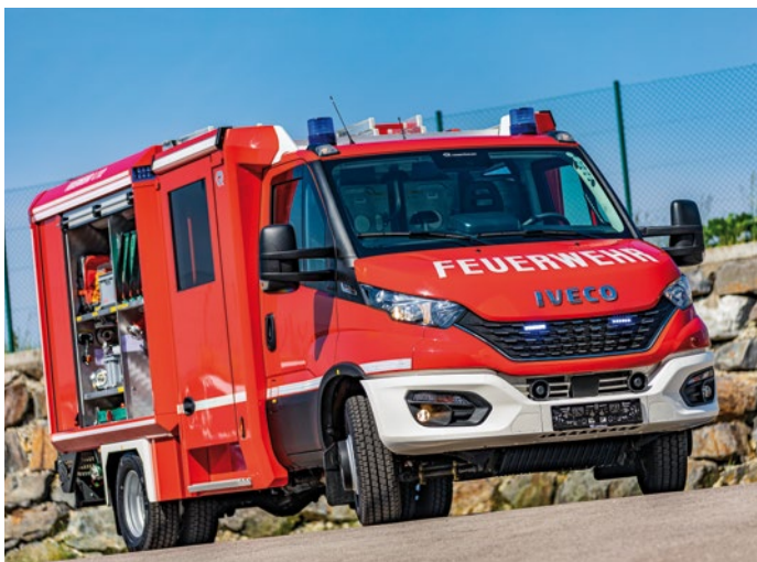
TSF-W: Im Fahrerhaus und am Pumpenarmaturenbrett lässt sich ablesen, wie viel Wasser sich noch im Tank befindet.
