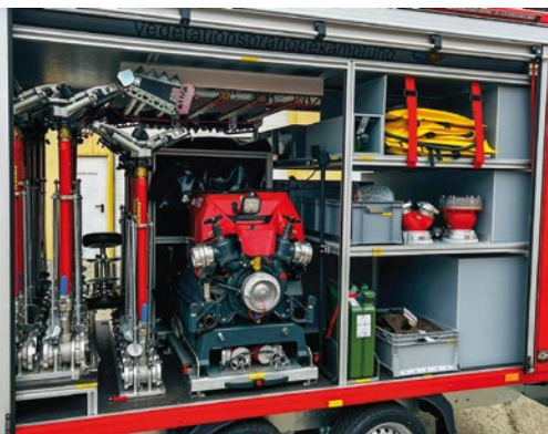
Linke Seite: Die Tragkraftspritze ist auf einem Schwerlastauszug verlastet.
