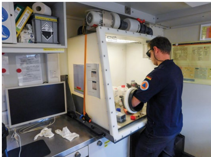
Kontaktlos: Die Glove-Box ermöglicht ein sicheres Arbeiten mit den entnommenen Proben.
