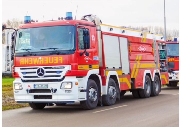
WF Dow: Zum Fuhrpark gehören auch zwei Universal-Löschfahrzeuge (ULF, Aufbau Rosenbauer auf ein MB 3246 8x4 Actros-Fahrgestell).
