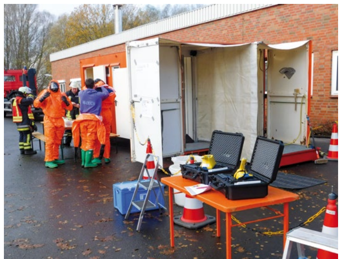
Dekon-Anlage: Sie ist in einem Abrollbehälter eingebaut und lässt sich relativ zügig in Betrieb nehmen.
