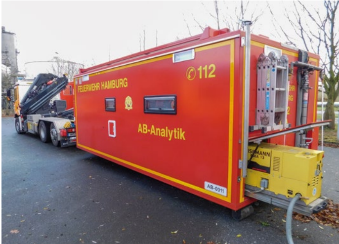
AB-Analytik: Der Abrollbehälter (AB) beherbergt eine mobile Laboreinrichtung für die ATF.
