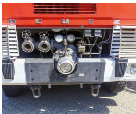
Hinter der Frontverkleidung: Hier befindet sich beim alten Fahrzeug die Einbaupumpe.
