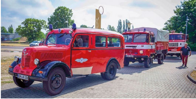
DDR-Technik: Ein Phänomen Granit 27 als Mannschaftstransportwagen und Zugfahrzeug vor einem LF 8 auf Robur LO 2002 A und einem TLF 16 auf IFA-W50-Fahrgestell.
